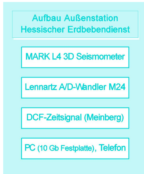
Abb.2 : Schematischer Aufbau einer Erdbebenstation.
